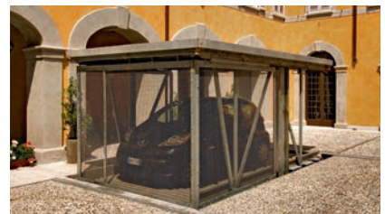
01 I Sicherheitsgitter sichern die Stellplätze im rückwärtigen Bereich, wenn die Anlagen auch von hinten oder seitlich begangen werden können. Safety fences secure the parking places in the rear area, as they can be entered also from the rear and side.
